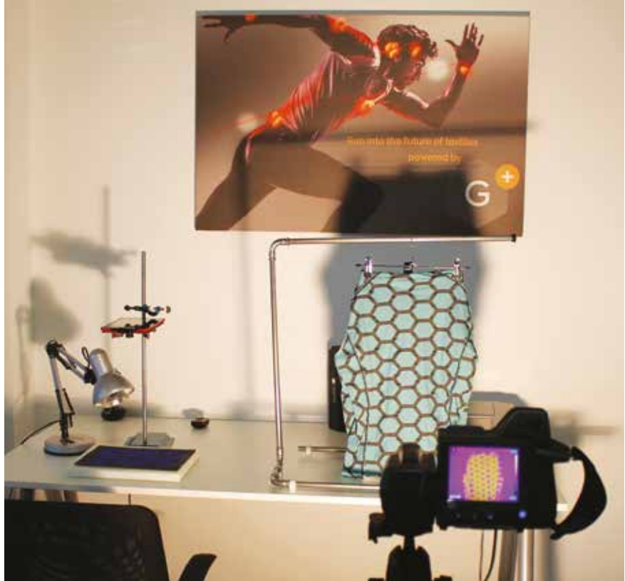
■ Test sulla dispersione del calore su tessuti trattati con tecnologia G+
