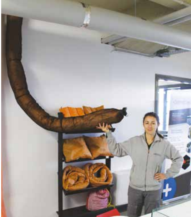
■ Una barriera oleo-adsorbente Grafysorber, leggerissima e super assorbente. A destra, la dimostrazione della capacità di assorbimento di olii e idrocarburi
