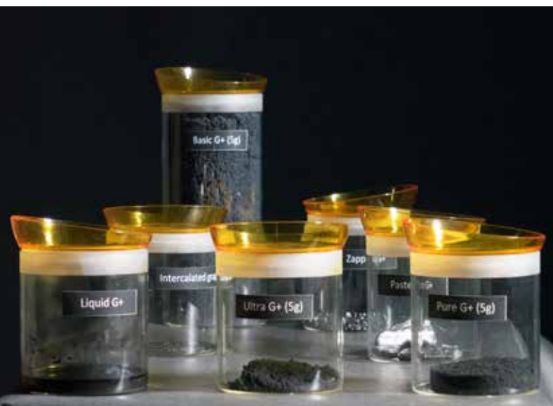
■ Directa Plus ha brevettato la tecnologia produttiva "G+" che consente di ottenere quattro diverse tipologie di materiali a base di Grafene, ciascuno con il proprio campo applicativo. Basic G+ (grafite super-espansa), Ultra G+ (fine polvere di nanografite), Liquid G+ (dispersione a base acqua di fogli di Grafene altamente puro), Pure G+ (polvere di fogli di Grafene altamente puro). A fianco, una "mattonella" di grafene, frutto di una delle fasi di produzione
