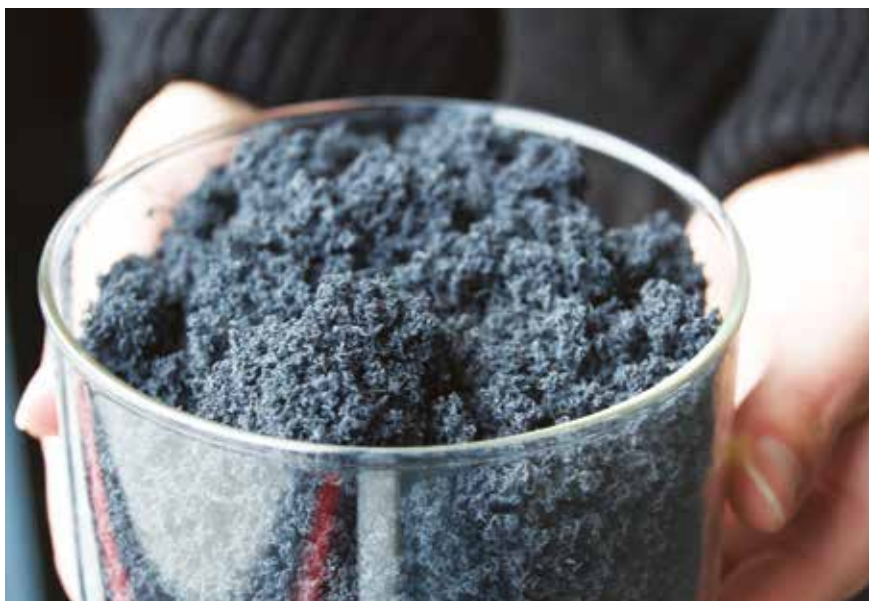
■ Una barriera oleo-adsorbente Grafysorber, leggerissima e super assorbente. A destra, la dimostrazione della capacità di assorbimento di olii e idrocarburi
